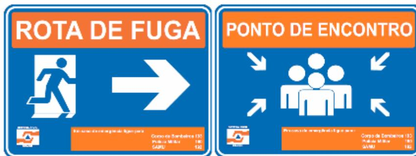
Figura 26 - Modelos de placas de identificação das Rotas de Fuga e Pontos de Encontro.
