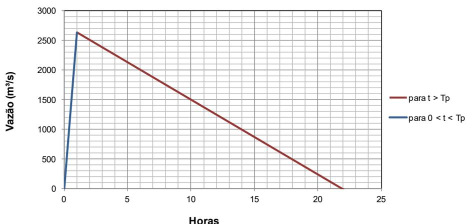
**Figura 15 – Hidrograma do cenário de ruptura do dique lateral esquerdo - Afluência 12.800 m³/s**
